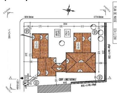
Il présente le projet dans sa totalité. Il permet de vérifier que les futures constructions respectent les différentes règles d'implantation et de hauteur, y compris par rapport aux constructions existantes, s'il y en a. Il permet également de connaître le projet d'aménagement du terrain, l'organisation des accès à la voie publique et des branchements sur les réseaux.
